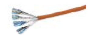
03086.E Экранированный кабель, кат. 6A S/FTP, 4 витых пары, 23 AWG, LSZH-оплетка, CPR Eca класса, I кат.(U0 = 400 V), оранжевый - 500 м
